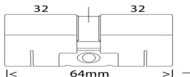
Les mesures sont prises en partant du milieu du trou de vis jusqu'à l'extrémité du cylindre. Il est donc possible que les deux côtés soient différents.
